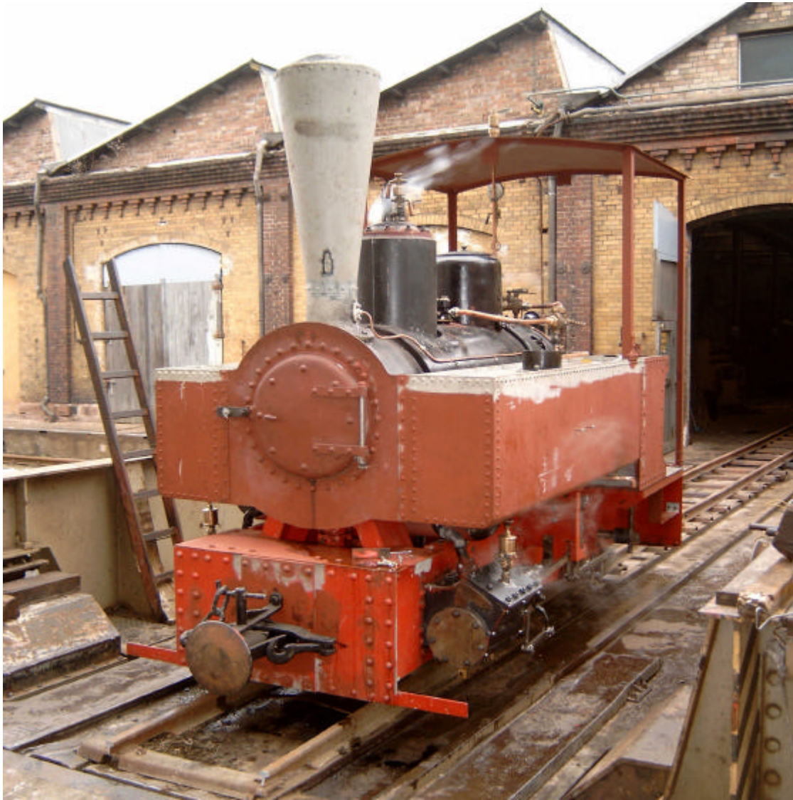
Lok 3, Decauville 648/1912 beim ersten Probeheizen in Benndorf. Foto Rüdiger Fach.
