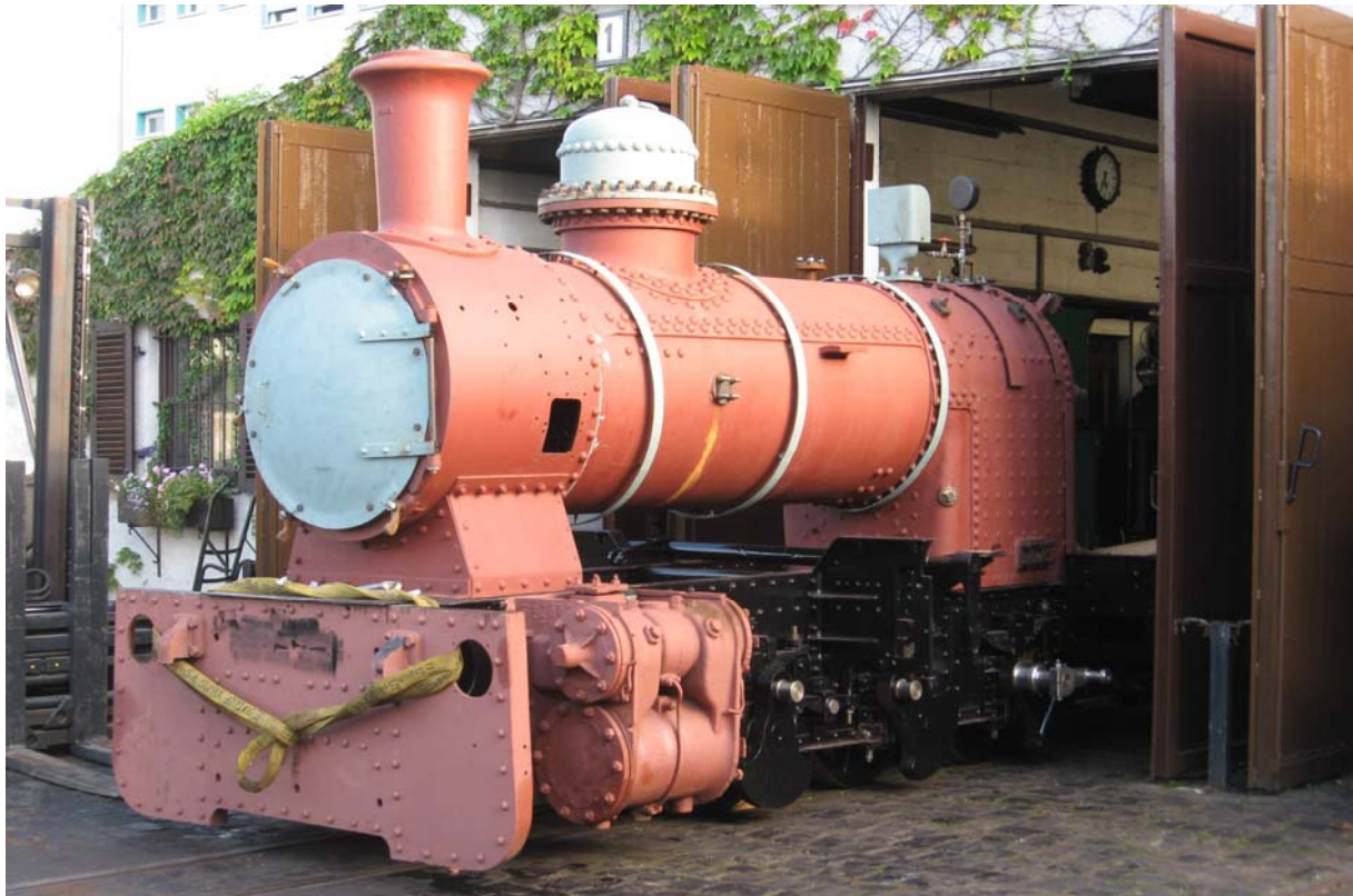
Lok 11, Cn2-Jung 10137/1952, Typ HF 110C. Der Kessel ist montiert und die Lok ist rollfähig. Foto: Udo Przygoda, 23.09.2009
